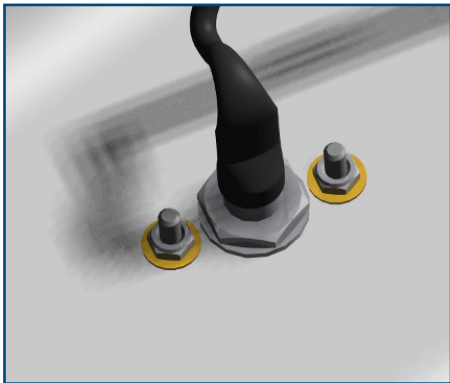
Klaar gemonteerde signalerings-led van de onderkant gezien
