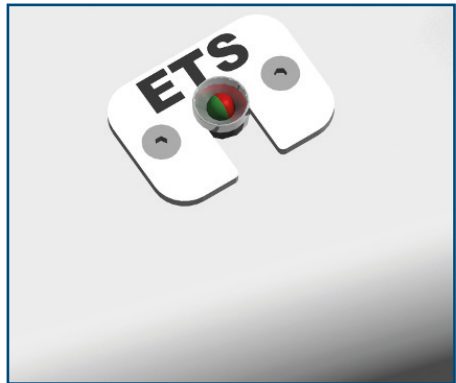
Fertig montierte Anzeige-LED von Oberseite gesehen
