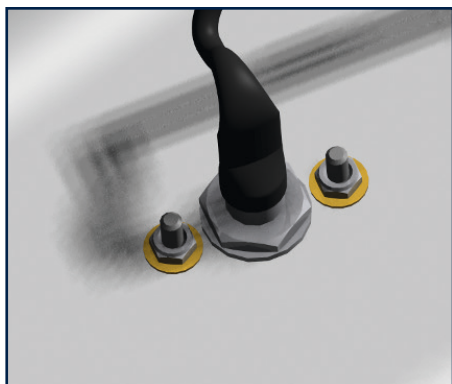
Färdig monterad indikerings-LED sedd underifrån
