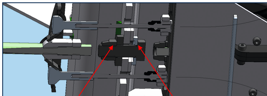
nakrętka zabezpieczająca M12 moment dokręcania 80 +10 Nm podkładka
