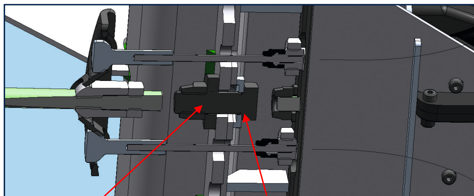
ロックナットM12 ディスク 締付けモーメント80 + 10 Nm
