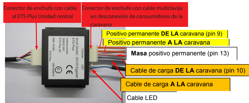
Figura. Cableado ETS Plus con desconexión de consumidores de la caravana
