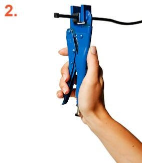
Mit Stufe 1 der Montagezange „Aspöck“ bis zum Anschlag pressen.
