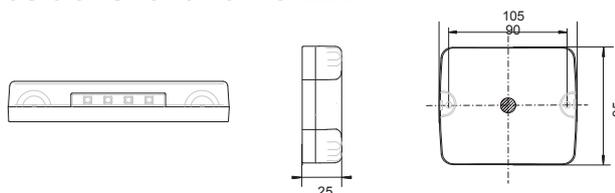
Rückfahrlicht ✓ Rückstrahler ✓ Nebelschlusslicht ✓
