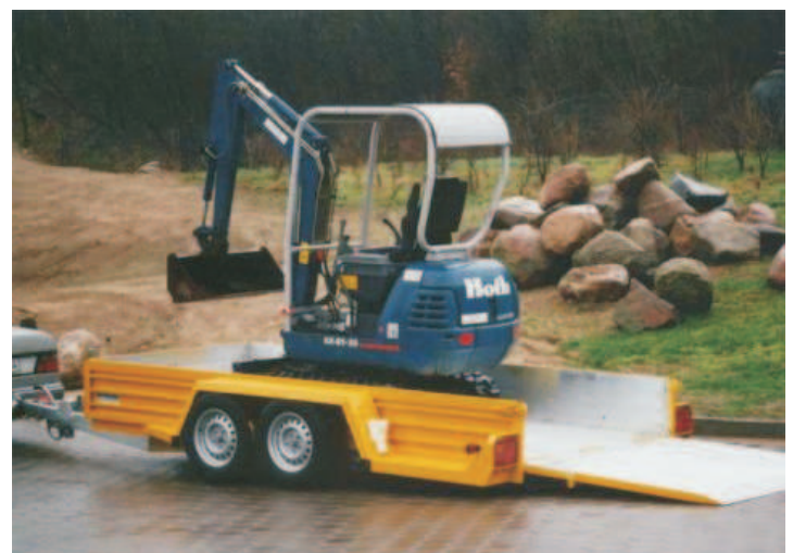
Kastenanhänger - extrem flacher Auffahrwinkel!
